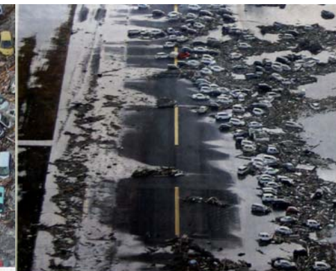
津波に襲われた仙台空港の滑走路。水が引いた部分には、おびただしい数の車と土砂が残された。12日午前7時40分、仙台空港
